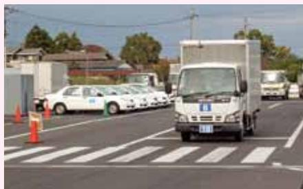
直線走行後、十分に減速して90度に左折。ハンドル操作と戻し操作がどうしても急になり、SRが低得点になりがち。約3秒をかけてゆっくり曲がる
