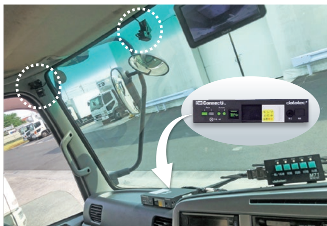
写真1 『SRVideo』から『SRConnect』に代わり、室内のカメラが追加され車内の様子が録画できるようになり、事故の原因特定に役立ったという。助手席のダッシュボード上にあるのが、SRConnect
