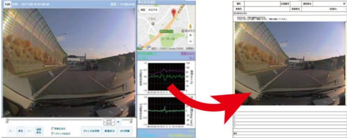
『クライアント管理ソフト』で日常写真と映像をアップロードすると、1日の運行中の1分1秒の日常写真と挙動発生時の映像が見れます。また、表示中の画面を危険予知トレーニング(KYT)シートとして利用できます。
