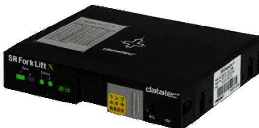
旋回中の加減速挙動、スイッチバック挙動、急ブレーキ・急発進を検出。旋回中に行う加減速は**荷崩れ** / **転倒事故**の原因。その挙動を検出して表示。
