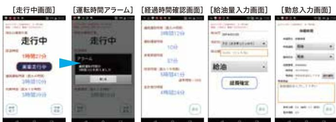
図3 スマホによるカードレス運用では、連続運転時間や高速時間の把握、連続運転アラーム、給油量/動怠時間などをドライバーが確認・入力できる
