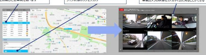
2秒間に1枚の画像を取得しコマ送りで確認することができます。 1度の取得要求に対し最大60枚=120秒間分の画像で確認する事ができます。
