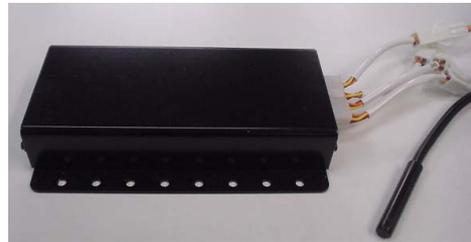
保冷庫の温度センサをセーフティレコーダに取込み、日報を出力します。品質保全に活用しています。
