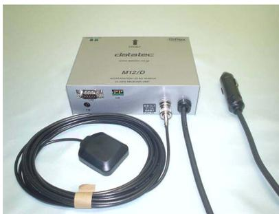
方位ジャイロ、前後加速度計を使用して、自律航法の演算を行い、GPSの受信できないトンネル内においても、あたかもGPSを受信できたのと同じように「位置」を出力します。
