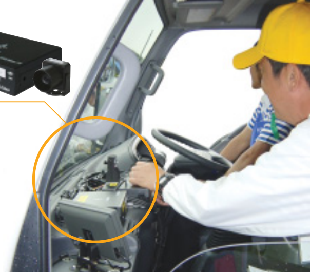
ダッシュボードに設置されたSR Video CCDカメラが固定されている
