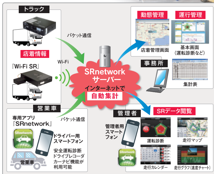
図1 SRnetworkの全体イメージ図。運行データをネットワークで一括管理しながら、運行管理、動態管理、カーナビ機能が利用できる統合型システム
