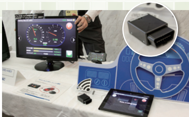
▲ SRお客様交流会のデータ・テックブースにて展示された『Safety RecⅡ-OBD-』。右上の「OBDアダプタ」を介し、スマートフォンと接続。モニタ画面に「速度」「エンジン回転数」「アクセル開度」「瞬間燃費」「アイドリング時間と燃費」などが表示可能
