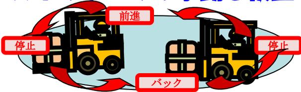
前進からバック、バックから前進に切り替える時、十分な停止時間があれば、安全確認をおこなうことができます。その停止時間をヒストグラムで表示します。
