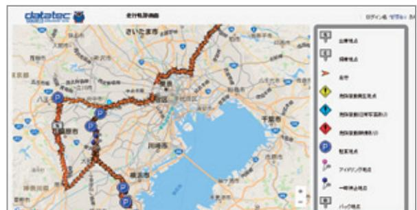
図8 車両の動態管理と連動しながら、ハザードマップで公道の危険地帯を表示。ドライバーに注意喚起を促す
