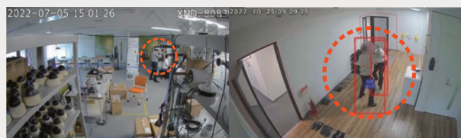
図1 左がヘルメット着脱状態を、右が喧嘩など異常行動を検知するAI監視カメラの事例
