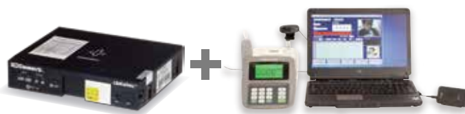
写真4 SRConnectとサンコーテクノ製アルコール検知機の連動で、点呼上の機能とデジタルの機能が一体化。運転作業日報として帳票出力が可能になった
